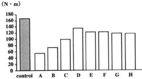
図2: 各種デザインによる先端部破断トルク
